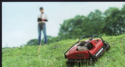
作業がしづらい場所も遠隔操作が可能
