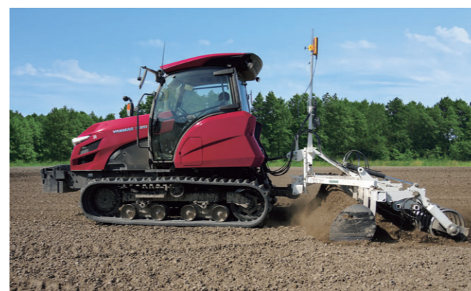
※写真はレーザーレベラー
